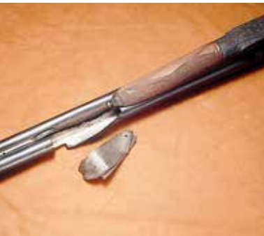
Laufsprengung als Folge einer nicht funktionssicheren Waffe
