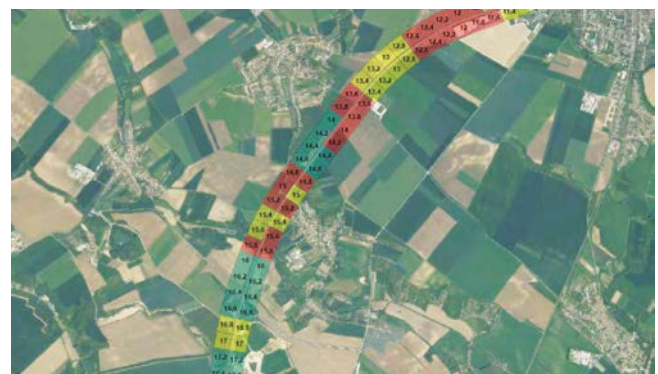
Abbildung 59: Beispiel aus einem Partnerprojekt in Tschechien: 200 Meter Farbklassifizierung zur Steigerung der Artenvielfalt an Straßenrandabschnitten der R52 (Brno - Pohořelice). Grün = geeignet, Gelb = zur weiteren Prüfung, Rot = ungeeignet
