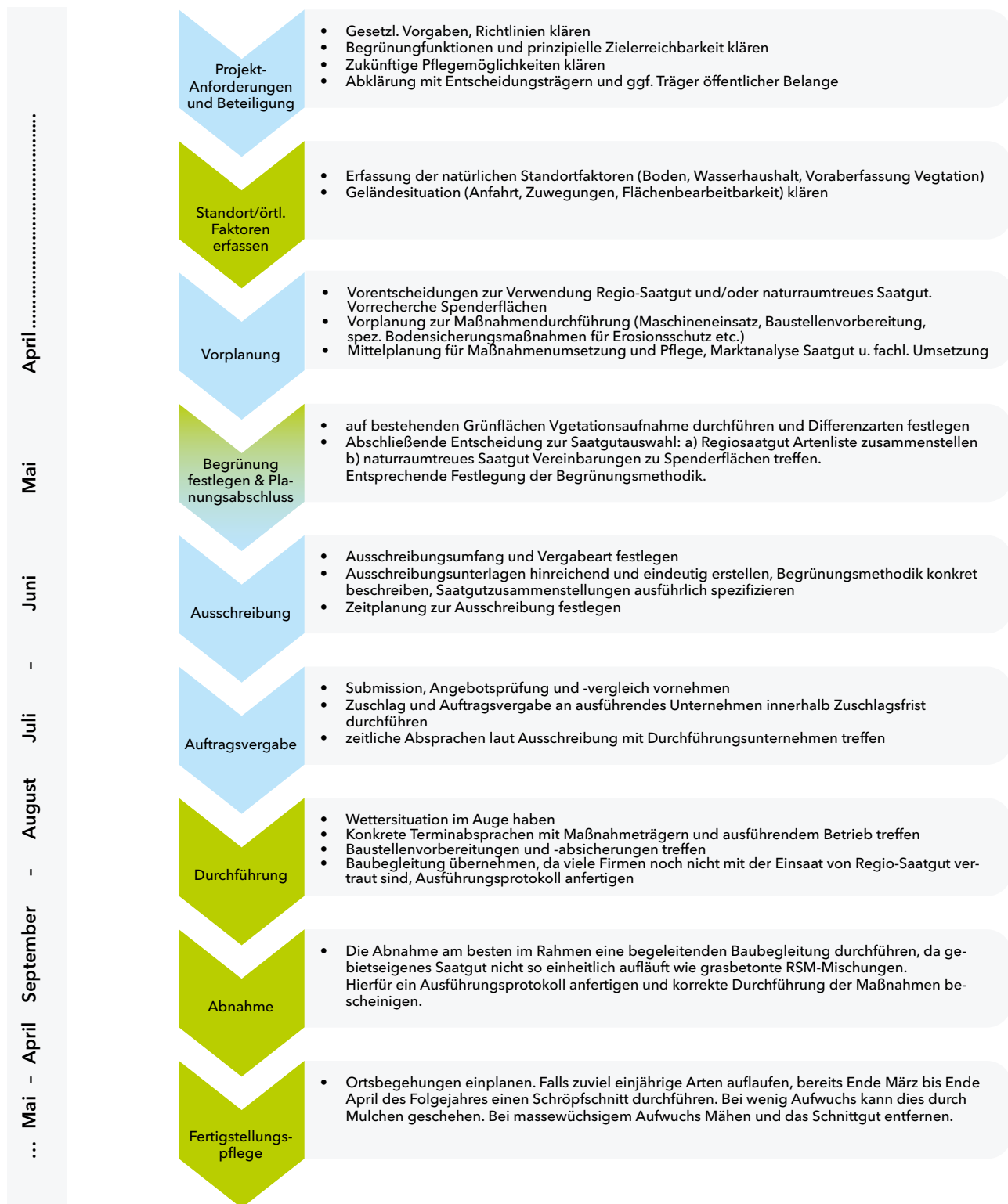
Abbildung 9: Projektablaufplan und zeitliche Umsetzung für die Anlage und Aufwertung von artenreichen Grünflächen (Außentermine sind in Grün dargestellt)
