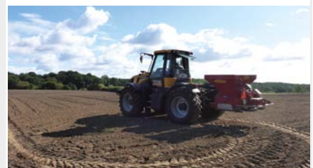
Abbildung 46: Ausbringung des Druschguts mit speziellem Tellerstreuer
